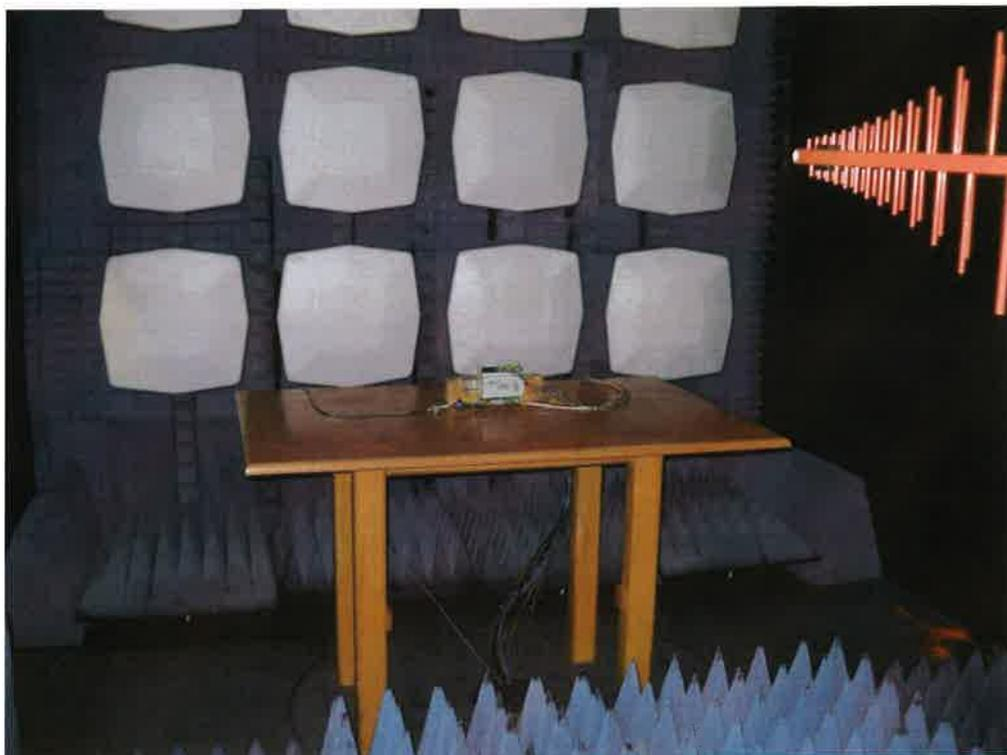
Figura 21. Disposición del EBE durante el ensayo de inmunidad radiada de RF.
