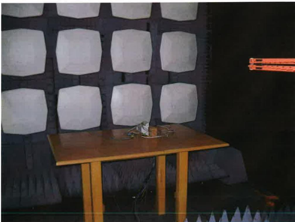
Figura 22. Disposición del EBE durante el ensayo de inmunidad radiada de RF.
