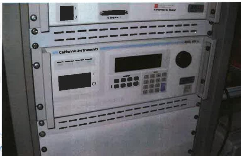
Figura 15. Equipo auxiliar. Fuente de alimentación programable DC/AC CALIFORNIA INSTRUMENTS.
