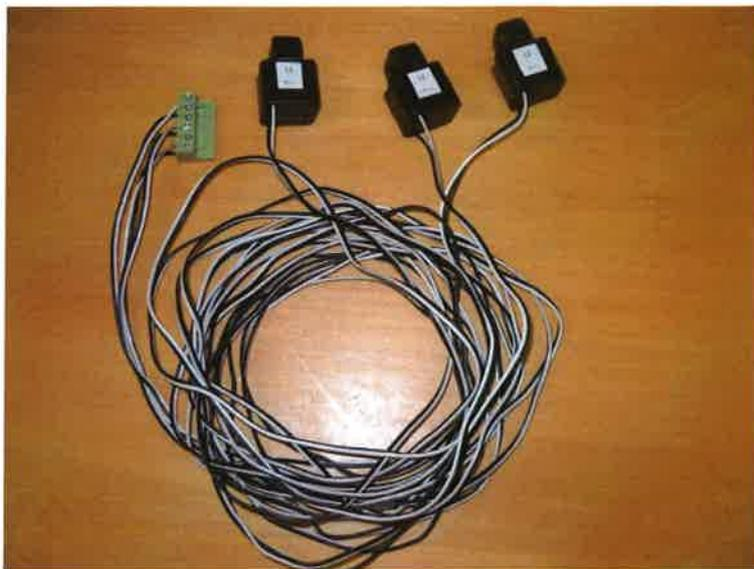
**Figura 11. Equipos auxiliares. Transformadores de corriente.**
