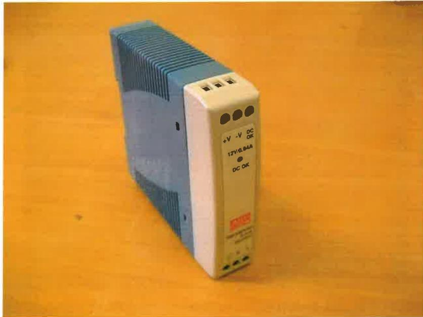
Figura 14. Equipo auxiliar. Fuente de alimentación 12Vdc.
