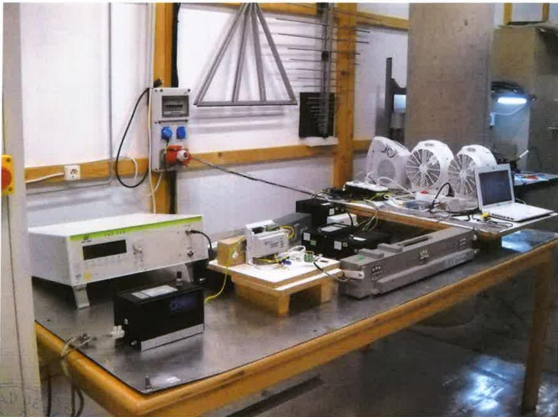
**Figura 27. Disposición del EBE durante el ensayo de inmunidad conducida de RF.
