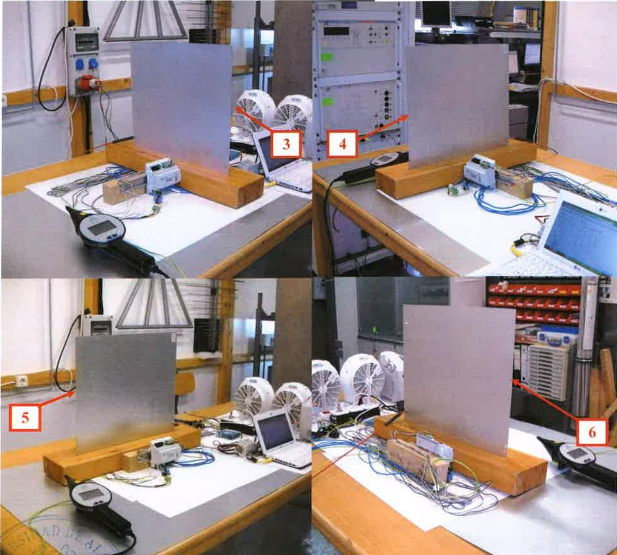
**Figura 20.** Disposición del EBE durante el ensayo de inmunidad a las descargas electrostáticas.
